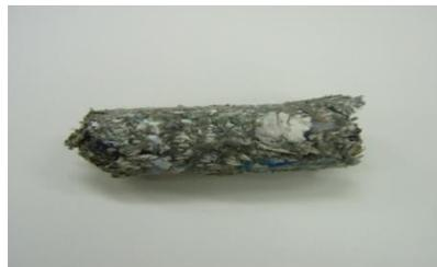
RPFに加工し、ボイラーのエネルギーとして再資源化
